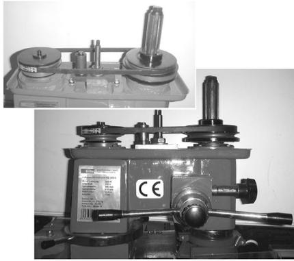
Durch Umlegen des Keilriemen im oberen Antriebskasten, kann die gewünschte Bohr- bzw. Fräsdrehzahl eingestellt werden. (Drehzahl siehe Tabelle.)
